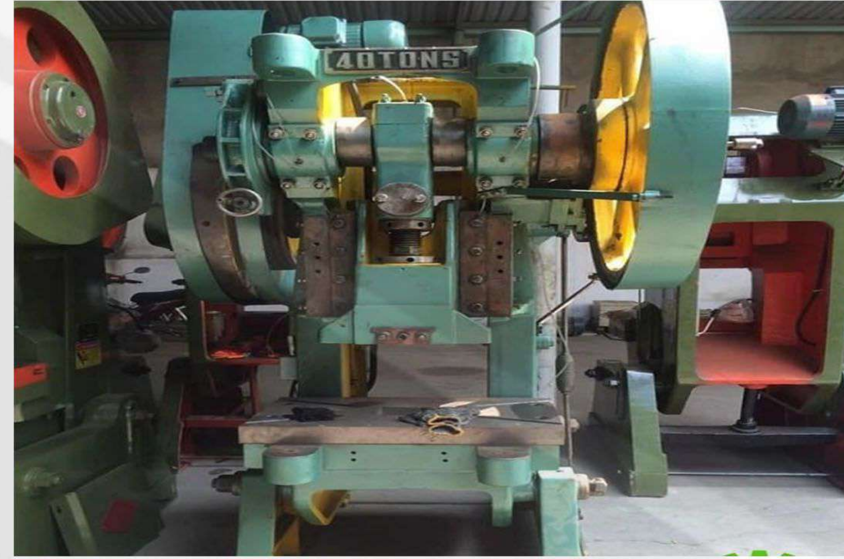
Máy dập 40 tấn/40 ton pressing machine
