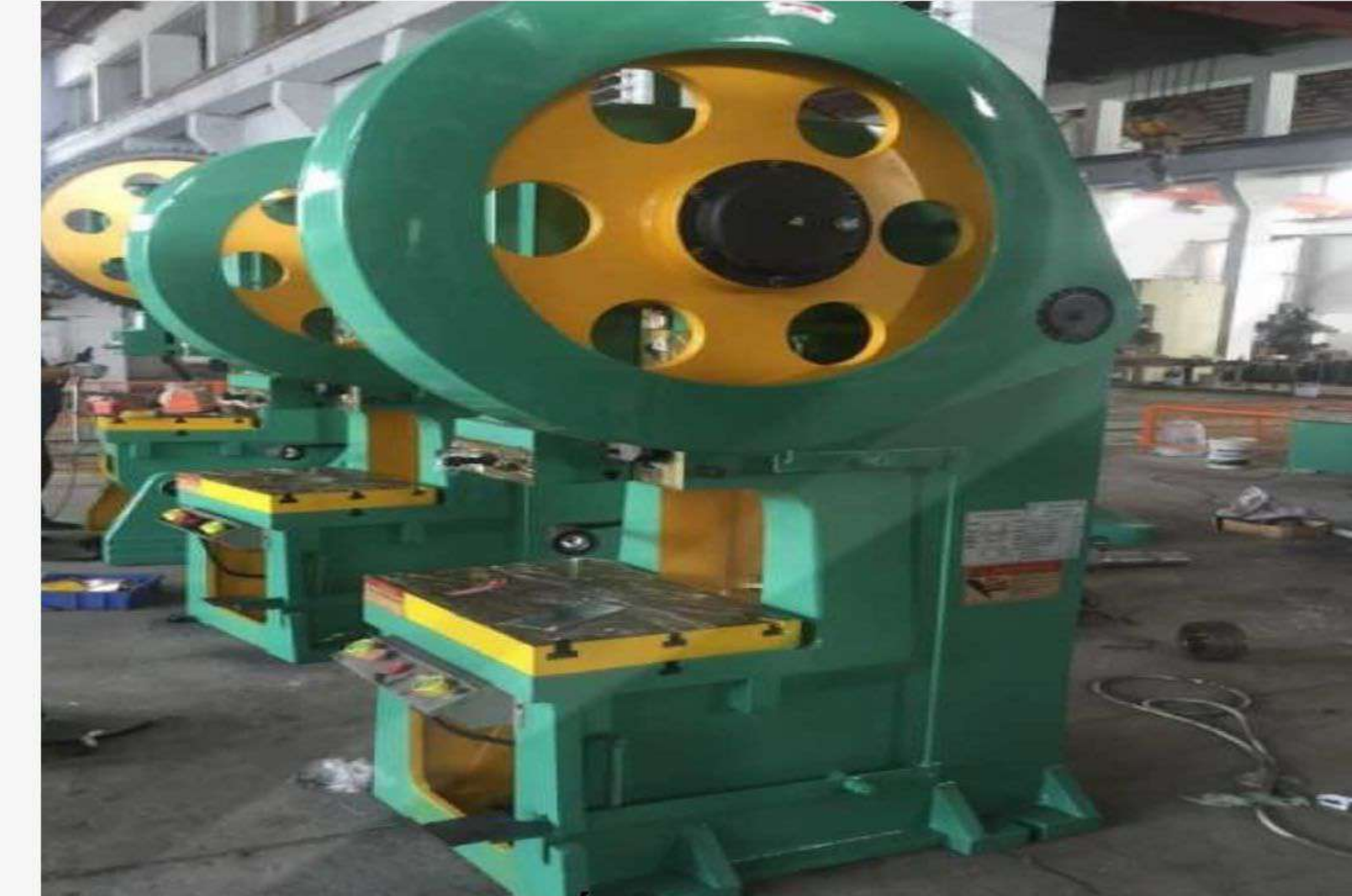
Máy dập 125 tấn/125 ton stamping machine
